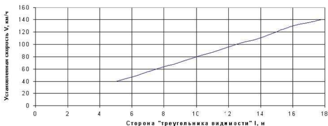
Рисунок 21 – Определение стороны треугольника видимости для пешехода
