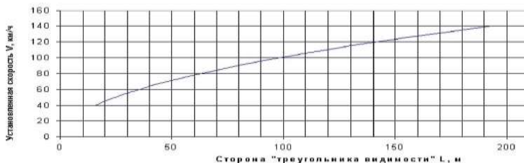
Рисунок 20 – Определение стороны треугольника видимости для транспорта
